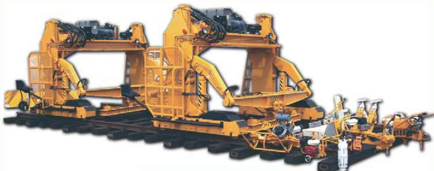
Pórtico gigante de vía
