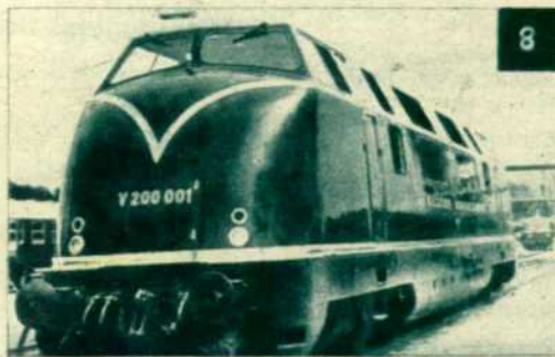
Locomotora diesel-hidráulica, tipo "standard", serie V 200, de los ferrocarriles alemanes
