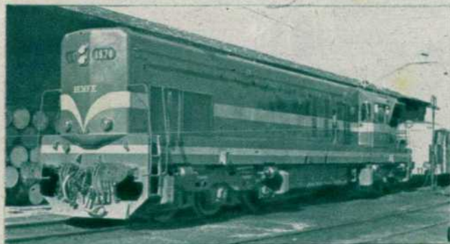
Locomotora diesel-eléctrica, serie 1900. Las correspondientes a los números 1961 a 1970, difieren de las anteriores de la misma serie en que sólo tienen una cabina de conducción
