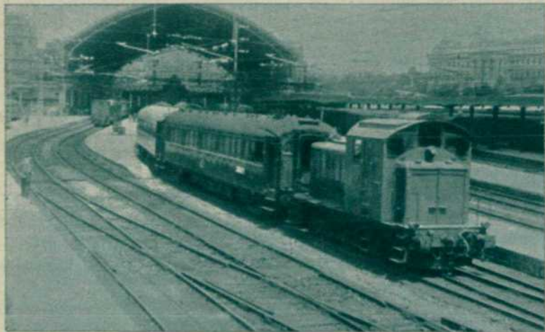
Locomotora diesel-eléctrica, serie 10.300, dedicada al servicio de maulobras
