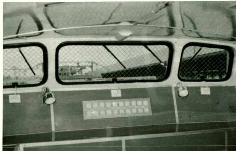
2 La cabina ofrece condiciones óptimas de visibilidad sobre la catenaria y el pantógrafo.
