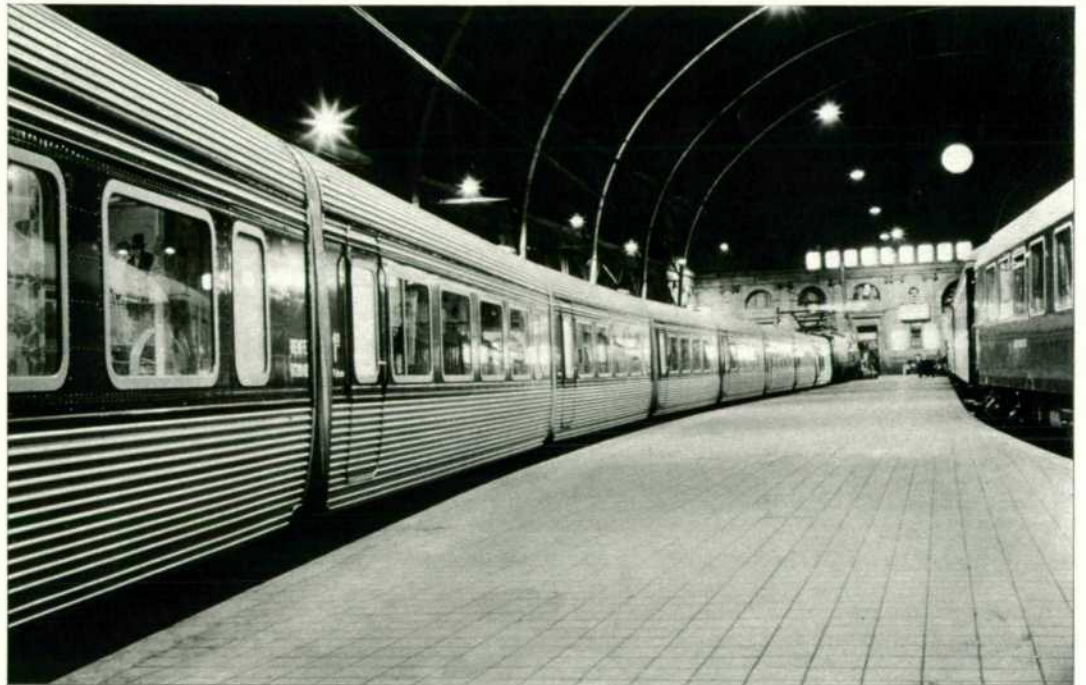
En la estación Término de Barcelona termina cada día un recorrido de 870 kilómetros que comienza en Ginebra. Durante la noche se revisan los órganos de rodadura y se atiende el mantenimiento de las ramas. Cada coche recorre, anualmente una media de 225.000 kilómetros.
