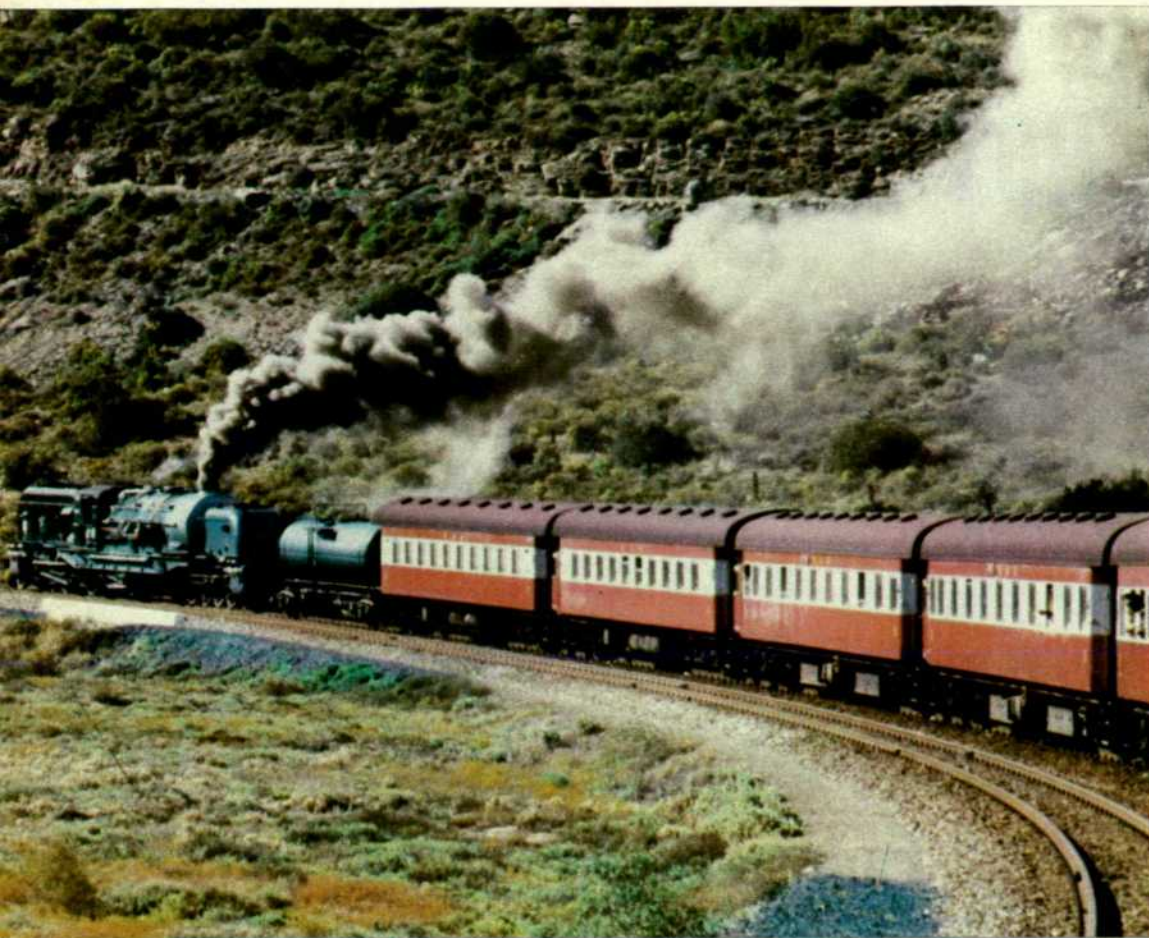
Tren de viajeros de los FF. CC. Sudafricanos (SAR), remolcado por una locomotora de vapor, tipo Garratt, en octubre de 1979.
