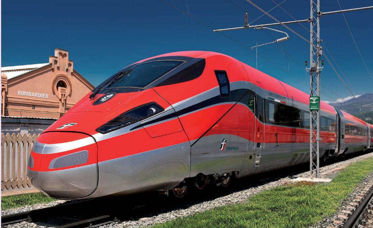
nientas toneladas, unas diecisiete por eje, y dispone de catorce puertas por costado, una de ellas completamente accesible. Los coches estarán equipados con suspensiones activas que compensan en el interior las fuerzas de aceleración y permiten mantener un alto nivel de confort a altas velocidades.
